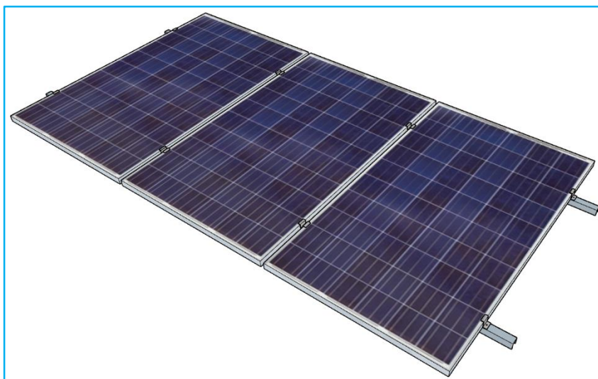
Figura 15 – Exemplo de instalação pelo Frame Longo.
