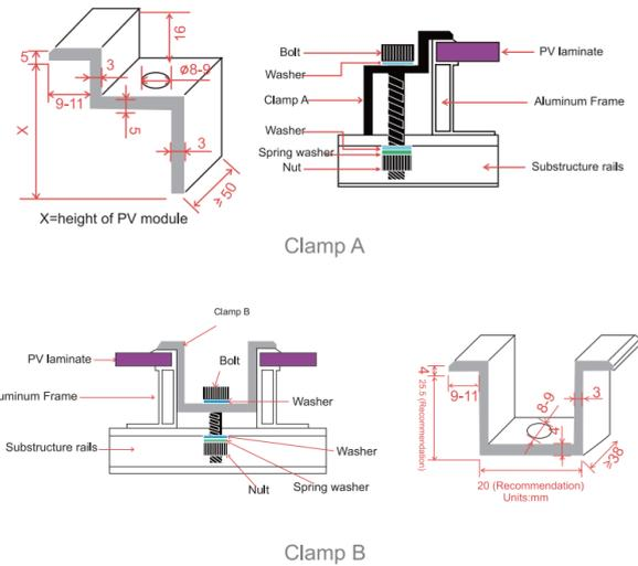
Figura 1: Detalhes de montagem (unidade: mm)
