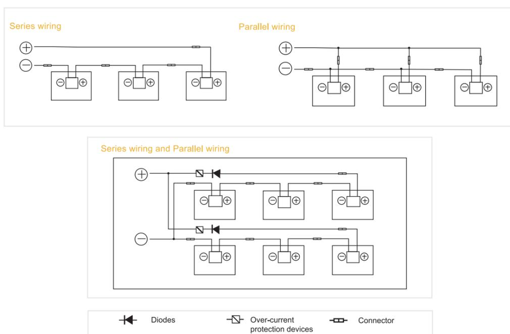
Figure 4 – Diagramas elétricos de conexões série e paralela
